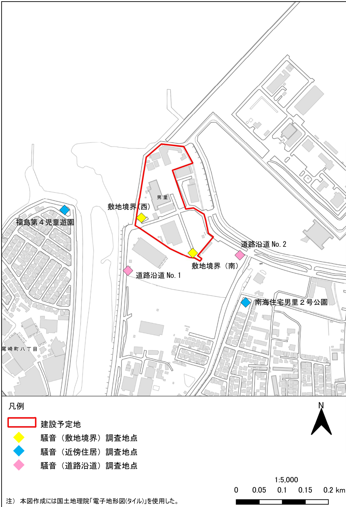
図4-2-1 騒音の現地調査地点
